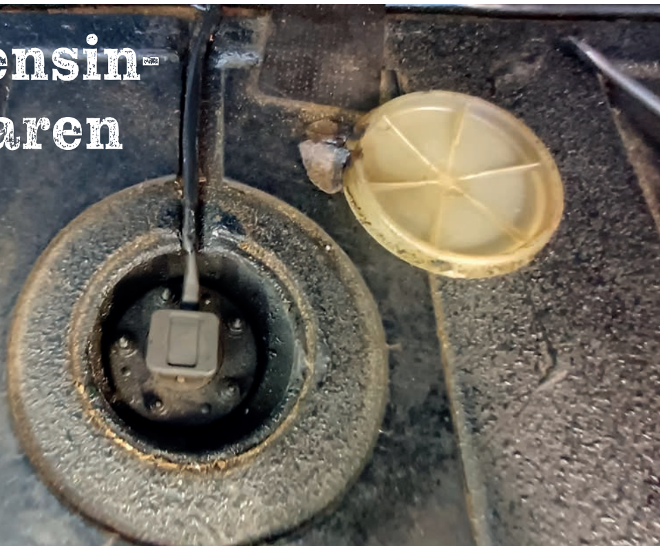
Typisk plassering av bensinmålar oppå sjølve tanken.
